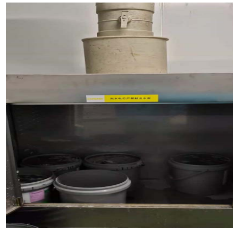
泡电池过程中电解液废气收集
